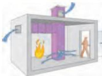
Conduit-gaine de ventilation **vertical** et **horizontal** assurant sa fonction de ventilation durant **120 min** avec **un feu extérieur**
